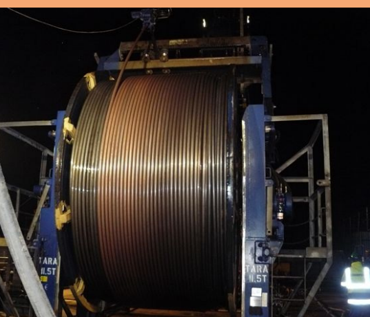
Coiled Tubing mit dünner Kupferschicht nach Einfahrt in den Reservoirbereich der Produktionsbohrung.
