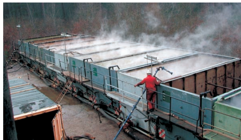
Fördertest nach hydraulischen Stimulationsexperimenten
