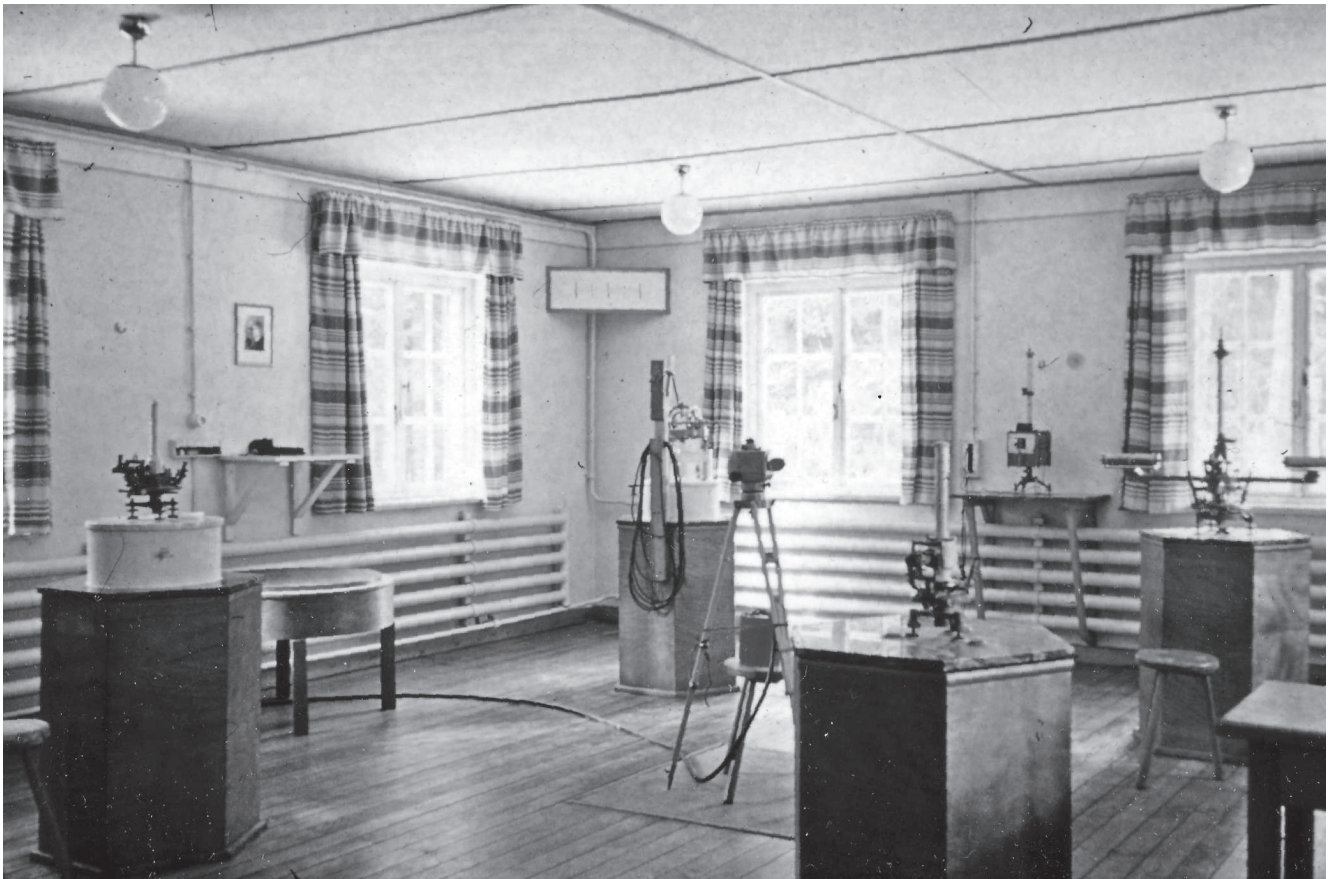
Abb. 2: Wingst, Absoluthaus, Blickrichtung NW (vor 1970). Zu sehen sind die folgenden Instrumente: Sockel SW: QHM, NW: Erdinduktor Schulze 552, NE: Stationstheodolit Schulze 75, SE: BMZ, Nordwand: Schwingungskasten zum Schulze 75, Stativ: Gfz Askania, darunter: Sensor des Protonenmagnetometers Varian 4931
